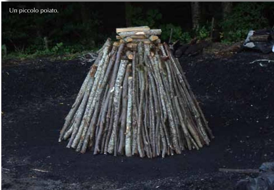
La produzione del carbone vegetale avviene con una tecnica che permette di togliere la quantità corretta di ossigeno al processo di combustione della legna, in modo da evitare da una parte che il fuoco si spenga e, dall'altra, che il fuoco prenda vigore e bruci la catasta di legna.
